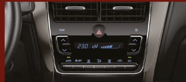
Aire acondicionado con climatizador automático digital. (1)
