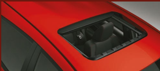
Techo solar eléctrico. (2)
