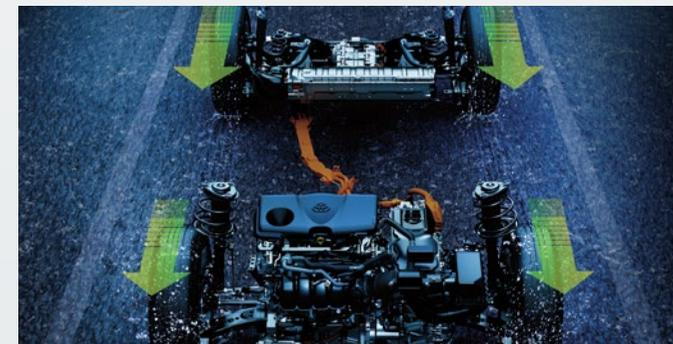
Se trata de un sistema de tracción electrónica inteligente denominado "e-Four" que proporciona torque en las 4 ruedas según la situación lo demande. Este sistema fue desarrollado para brindar una conducción propia de un SUV y una excelente eficiencia en combustible.
