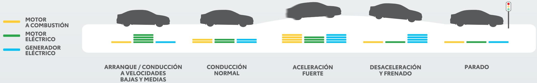
A diferencia de los vehículos convencionales que funcionan gracias a un motor de combustión interna, un auto híbrido es impulsado por la energía que le proveen sus dos motores, uno naftero y otro eléctrico.
