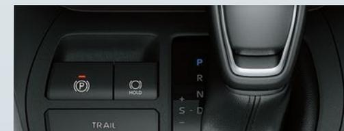
FRENO DE ESTACIONAMIENTO ELÉCTRICO CON FUNCIÓN "AUTO-HOLD".
